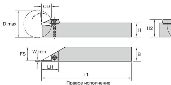
■ Державки с прямоугольным хвостовиком, крепление сверху • Метрическая система
